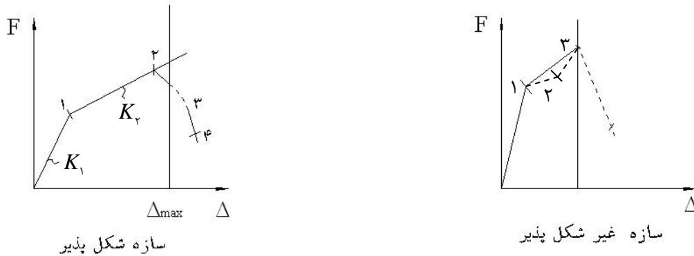
شکل ۸-۶ - نمونه منحنی‌های ساده‌سازی شده رفتار تقریبی کلی سیستم برای سازه‌های شکل پذیر و غیر شکل پذیر
